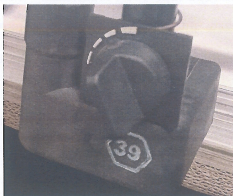
Рис.6. Регулировка подачи сжатого воздуха в задних раздувателях, щупе-сопло, вакуума в присосах.
